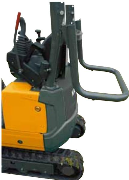
Il 12VXE è in grado di oltrepassare una porta con luce minore di 90 cm. Inoltre si può smontare il rollbar in pochi minuti per facilitare passaggi sotto altezze minime.
