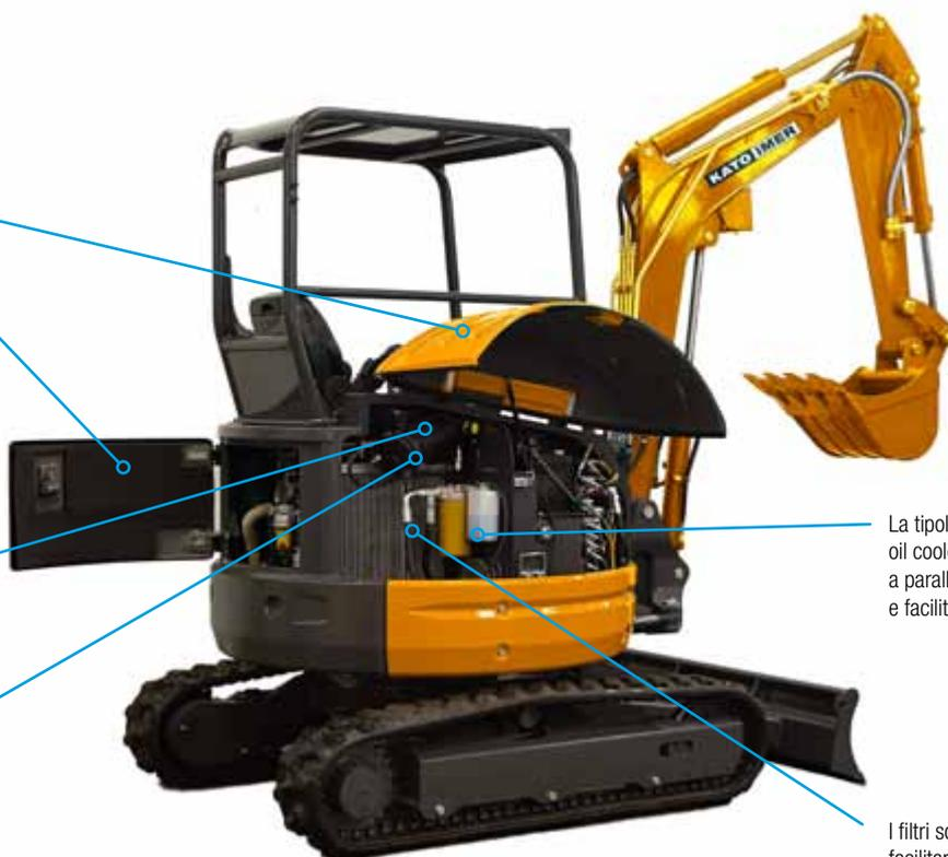
La tipologia del radiatore e oil cooler è cambiata da seriale a parallelo "Side-by-side cooler" e facilita la pulizia
