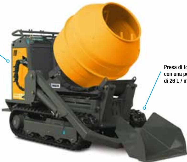
Presa di forza standard con una portata maggiorata di 26 L / min mono-bidirezionale
