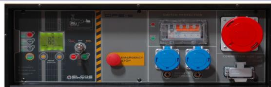
Il quadro QPE-B, con logica a microprocessore, serve al comando e controllo del gruppo elettrogeno in funzionamento manuale o automatico. Tramite un display a cristalli visualizza i parametri elettrici e fisici del gruppo e gli allarmi motore e alternatore.
